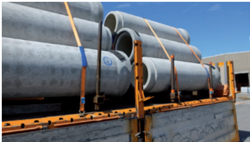
Kreisrunde Betonrohre nach der Verladung und Sicherung auf einem Lkw.
