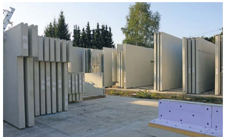
Lagerung von Wandelementen im Werk.
