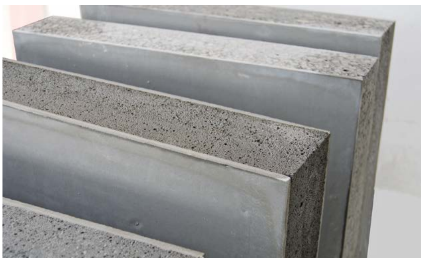
Hybridbeton-Elemente mit UHPC Deckschicht.
