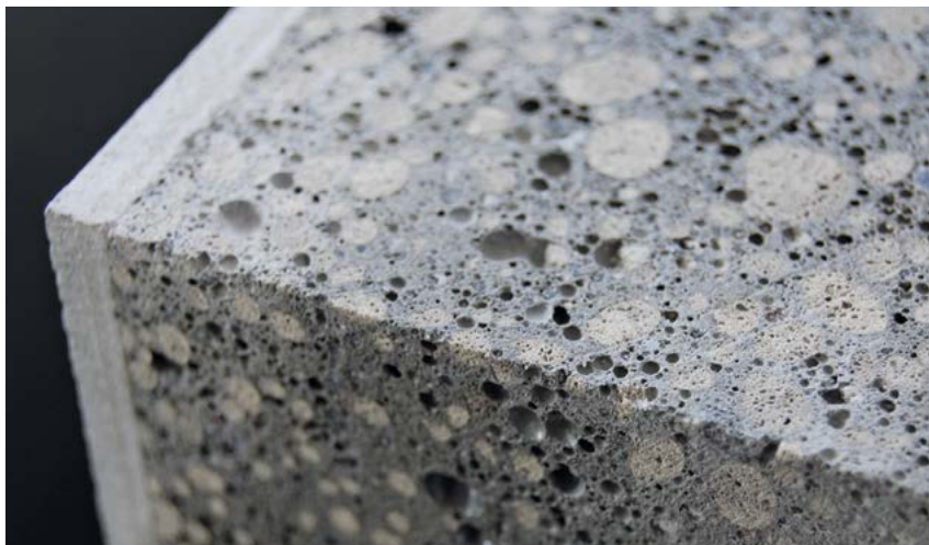
Spezifische Materialmatrix der Hybridbeton-Elemente mit Aerogel-Schaumbetonkern.
