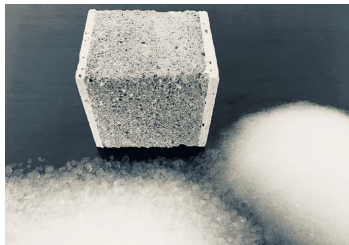
Schaumbetonprobekörper in Kombination mit Aerogelpulver.
